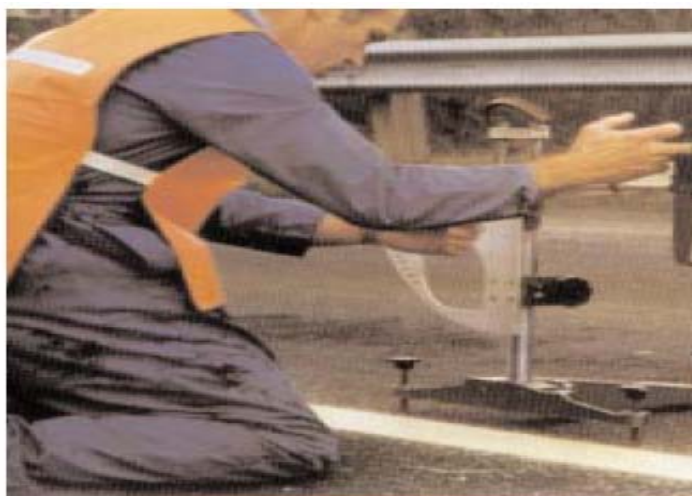
شکل ۳-۴: دستگاه اندازه‌گیری مقاومت لغزشی خط‌کشی‌ها
